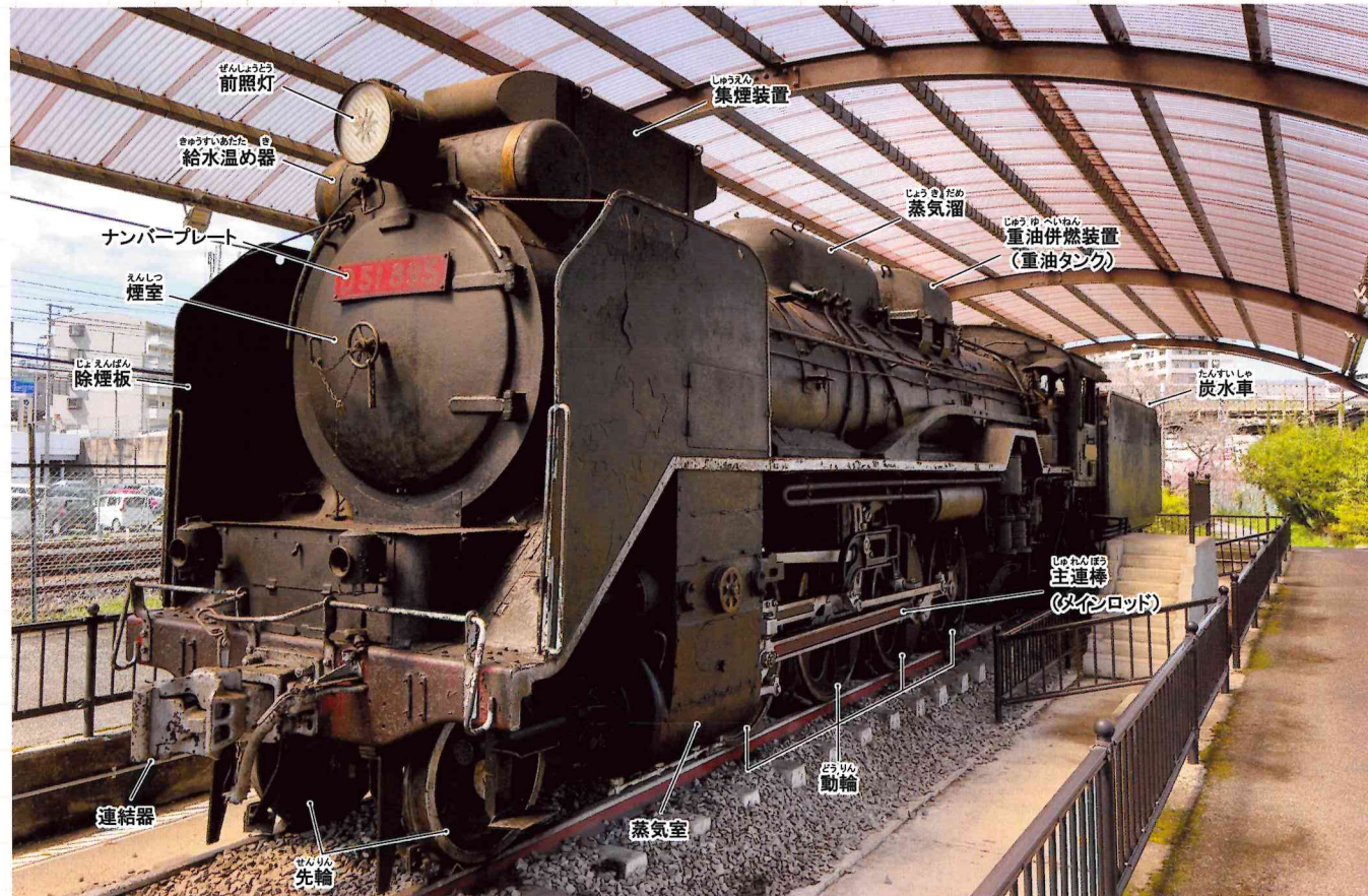
▲舟戸児童公園に静態保存されるD51形蒸気機関車895号機 公式側前方から見た全景写真です。煙突部分に集煙装置、蒸気溜がある流線形カパーの後ろに重油併燃装置の重油タンクが装備されたまま保存されています。
