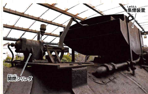
▲集煙装置と開閉シリンダ トンネル内では集煙装置の蓋を空気シリンダで閉めて煙を後方へ逃がします。
